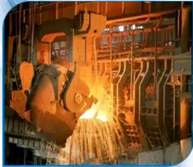
Непрерывная разливка стали
